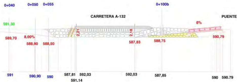
PERFIL LONGITUDINAL ACCESO A ANTOÑANA ESCALA 1/500
